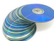
CDs und DVDs bestehen überwiegend aus Polycarbonat, einem hochwertigen und verhältnismäßig teuren Kunststoff. CDs und DVDs lassen sich mit geringem Aufwand recyceln. Aus dem aufbereiteten Polycarbonat können zum Beispiel Produkte für die Medizintechnik,
